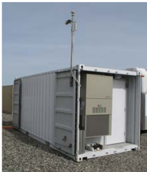
移動型希ガス観測装置(TXL: Transportable Xenon Laboratory)
